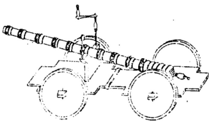
九節十成礮鑄銅。前後若一。前分九節。後加底。各有螺旋。分負以涉險遠。用時合成之。重自七百九十觔至七百九十八觔。長自五尺一寸至六尺九寸。底環螭三。每節飾獸面三。分鎬重若干。受藥自一觔四兩至一觔八兩。鐵子二觔八兩。載以四輪車。通髹朱軫平。施輪處少闊。長六尺一寸。中加立木半規。以承礮。立木左右為鐵柱。夾礮。右柱長倍左。曲向前。加立表以為準板。輪不施轂。
