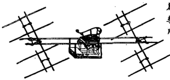
皇帝鹵簿輕步輿。木質髹朱。不施幙蓋。通高三尺四寸。倚高一尺五寸八分。象牙為之。座高一尺八寸二分。縱一尺八寸三分。橫二尺二寸。踏几高三寸。縱九寸。橫二尺一寸五分。髹以金。直轂二。各長一丈五尺四寸五分。加銅龍首尾。大橫杆二。各長九尺一寸。小橫杆四。各長二尺八寸四分。肩杆八。各長五尺八寸五分。皆鈎以銅。餘如步輿之制。异人數同。
