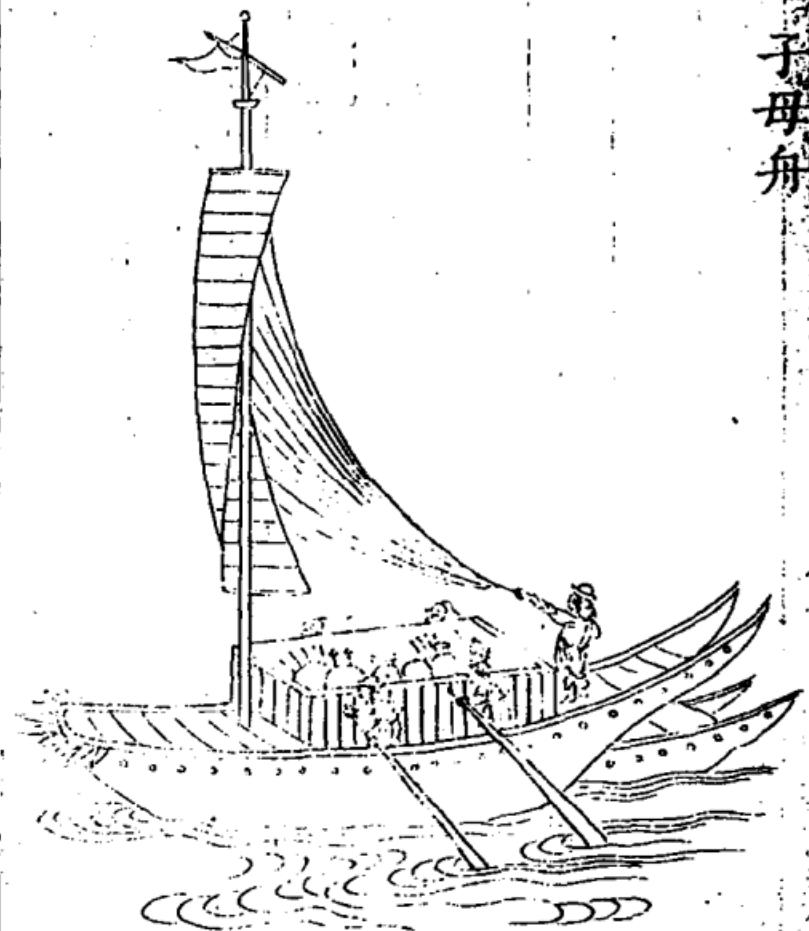
子母舟長三丈五尺、前二丈如艦船樣、後一丈五尺、只兩邊幫板、腹內空虛、後藏一小舟、通連一處、亦有蓋板掩人、兩邊四棹、前母船使風送棹槳、前艙內裝以茅薪油藤、縛沃交貫、火藥粗線、船前兩腋、俱用狼牙釘錠、背用鋼尖快利、或迎抵彼船艙內、發鈎拒掉搭咬溜索、與彼相連一處、先往船上放箭砂等具、卽將我母船發火、與彼并焚、我軍後開子船而歸
