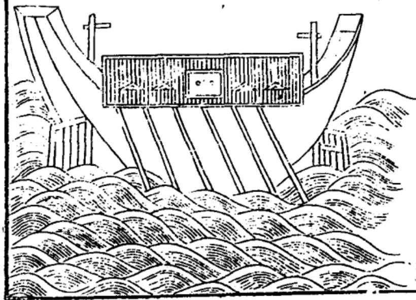
崇明沙船奇巧接戰、但上無壅蔽、火籠矢石何以禦之、不如鷹船兩頭俱尖、不辨首尾、進退如飛、其傍皆茅竹板密釘如福船傍板之狀、竹間設窓可出銃箭、窓之內船之外、隱人可盡槳、先用此舟冲敵入賊隊中、賊技不能却、沙船隨後而進、短兵相接、戰無不勝矣、鷹船沙船乃相須之器也。
